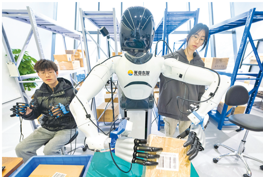
在湖北人形机器人创新中心,数据采集员操作人形机器人进行仓库搬运场景的数据采集。 新华社记者肖艺九 摄
